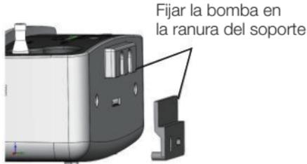
6.3 Poner la tubería desagüe del sistema en la entrada de agua de la bomba y conectar la salida con una tubería de vinilo 6x9mm, fijarla con una abrazadera.
